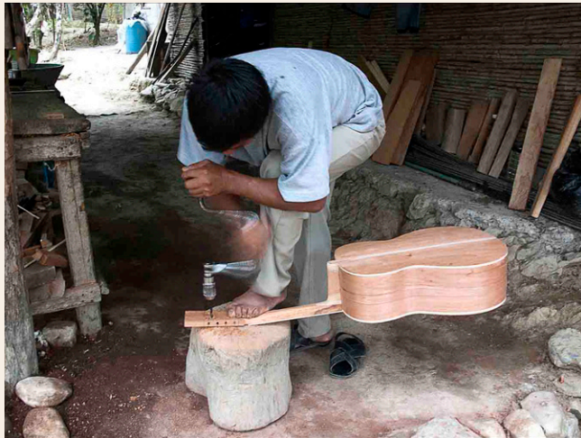
FIG 2. SOSTÉN DE INSTRUMENTO EN PROCESO PARA LA ELABORACIÓN DE HOYOS DE CLAVIJAS Y CANALES PARA MAQUINARIA. TEXQUITOTE, S.L.P.
