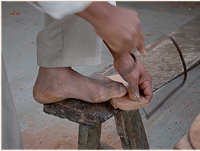
FIG 1. SERRUCHADO DE PIEZAS PEQUEÑAS Y RÍGIDAS (MADERA PARA DIAPASONES, PUENTES Y CLAVIJAS).
